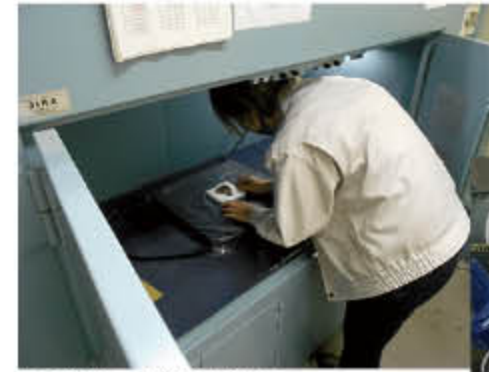
金属製品のX線透過検査
